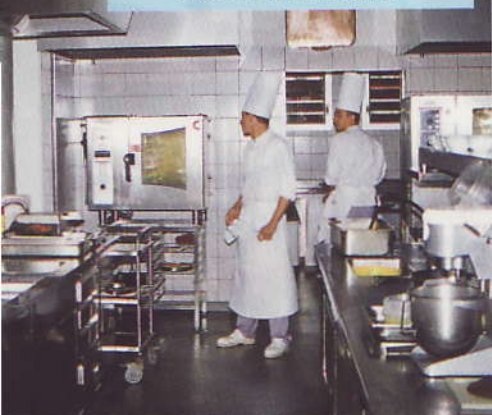
La Brasserie de l'Ouest est équipée d'un four avec sonde à cœur intégrée.
